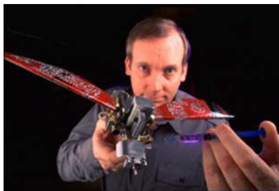
Fig. I. 25. Ornithoptère propulsé par des "muscles" chimiques
