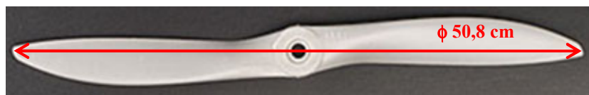
Fig. II. 18. Hélice APC 50,8 x 28
