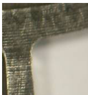
Fig. IV. 24 : Arrondis à l'intérieur de la pièce
