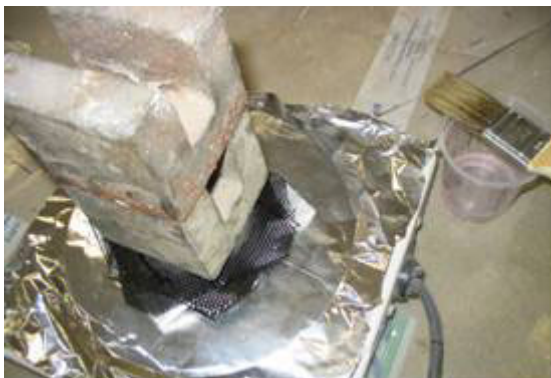
Fig. IV. 11. Résine chargée par addition de charge
