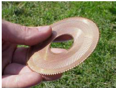
Fig. III. 26. Bobinage du rotor AXEM
