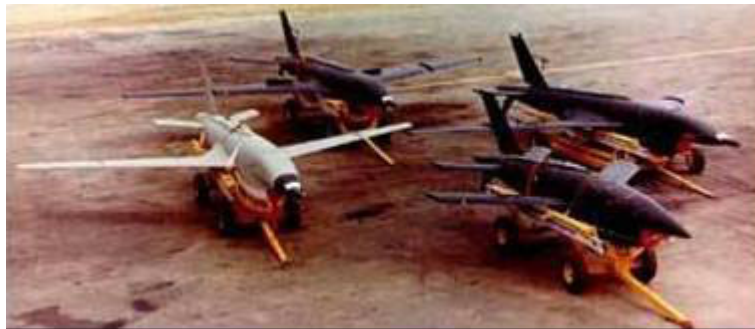
Fig. I. 3. Différents modèles du Ryan 147 (de gauche à droite : 147J, H, G, NX)
