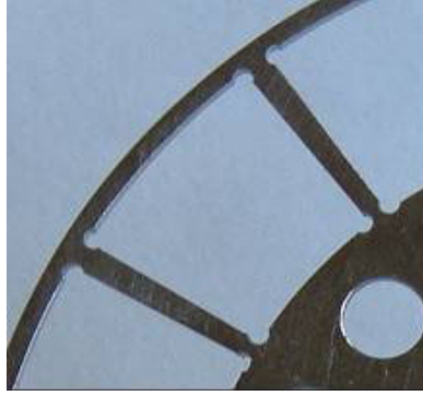
Fig. IV. 26. Coins percés dans l'armature \phi 70 mm pour éviter la retouche des aimants
