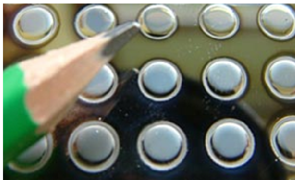
Fig. III. 7. Aimant en NdFeB déposé par plasma (LLN)
