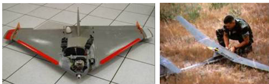
Fig. I. 9. Les premiers minidrones utilisés pendant la guerre du Golfe : l'Exdrone et le Pointer (1991)
