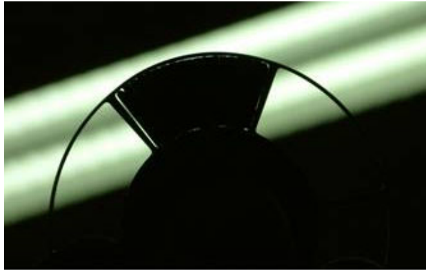
Fig. IV. 27 : Secteur 1 monté avec des pôles trop pôlis
