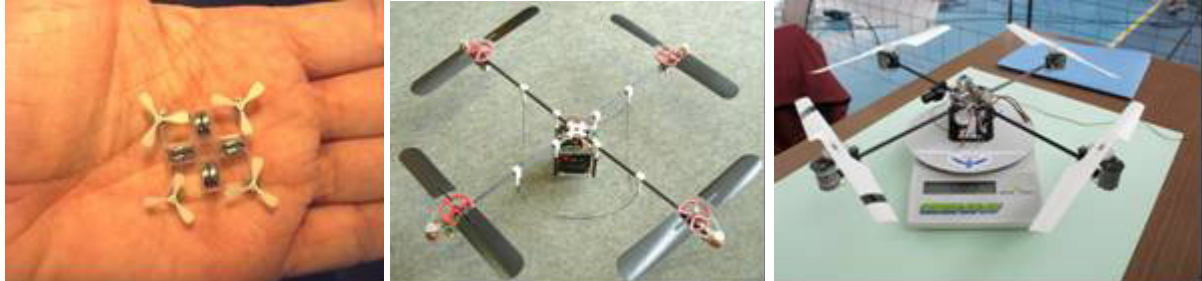
Fig. II. 6. Configurations quadri-rotor 6. a. Projet Mesicopter, Stanford [MES00] 6. b. Projet OS4, EPFL [OSF05] 6. c. Projet CPX04 [CPX04]
