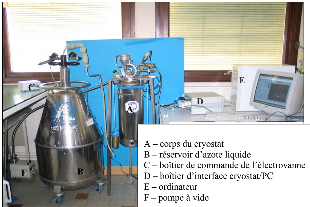
Fig.4.1. Vue d'ensemble du dispositif cryogénique de vitrification.
