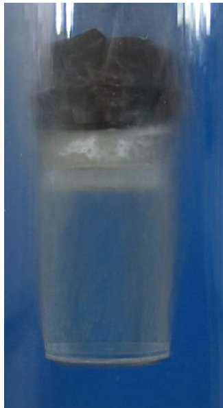
Fig 3.12. Vitrification du VM3 réussie dans le container cylindrique
