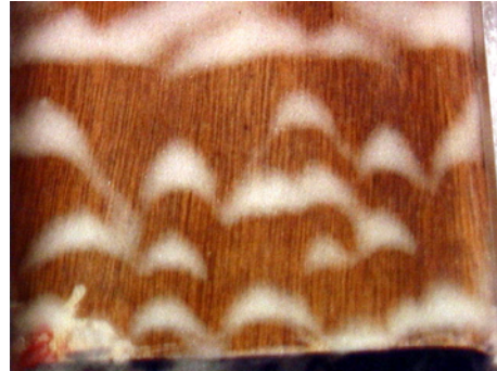
FIG. 2.5 – Premières formes barchaniques obtenues avec l'expérience "prototype". A partir d'un lit de sable, des formes en croissant de taille centimétrique apparaissent après environ 50 oscillations de la plaque.
