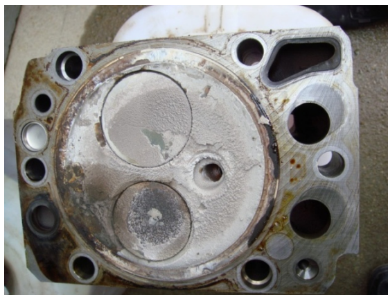
Figure IV- 13 Moteur endommagé par la présence de siloxanes dans le biogaz
