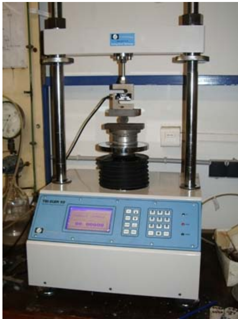
Figure 16 : Dispositif expérimental de l'essai « brésilien », petite presse Tri-Scan 50 du laboratoire 3S.
