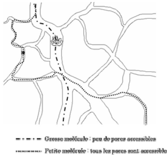
Figure 2-7 : Chemin parcouru à travers une colonne de CES par deux polymères de R_H différents.
