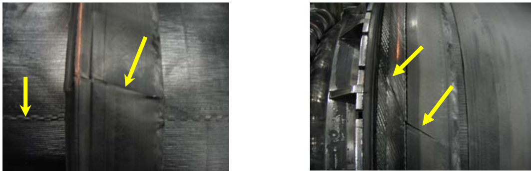
Figure 1-1 : Exemple de soudures sur les bandages.
