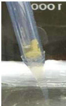
Figure 149 : Aperçu du milieu réactionnel entre l'UF<sub>6</sub> liquide et les oxydes métalliques (ici Al<sub>2</sub>O<sub>3</sub>)
