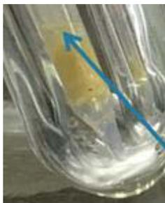
Figure 156 : Aperçu de l'échantillon d'oxyde de bismuth au cours de sa réaction avec l'UF<sub>6</sub> liquide.
