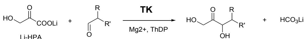
**Figure 85 : Réaction catalysée par la TK en présence de Li-HPA et d'un aldéhyde**
