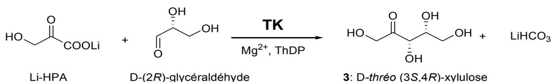
**Figure 64 : Synthèse du D-xylulose catalysée par la  $mTK_{gst}$**
