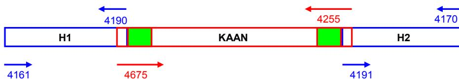
**Figure 78 : Obtention des cassettes comportant les deux séquences dégénérées (vert) et les deux séquences homologues au plasmide H1 et H2 (en bleu)**
