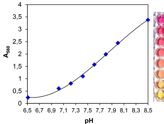
**Figure 93 : Courbe de l'absorbance en fonction du pH**
