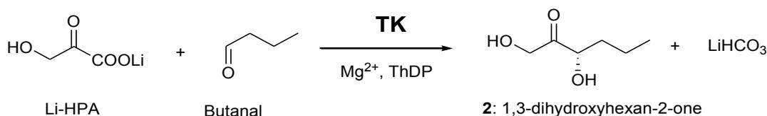
**Figure 63 : Synthèse de la 1,3-dihydroxyhexan-2-one catalysée par la mTK<sub>gst</sub>**
