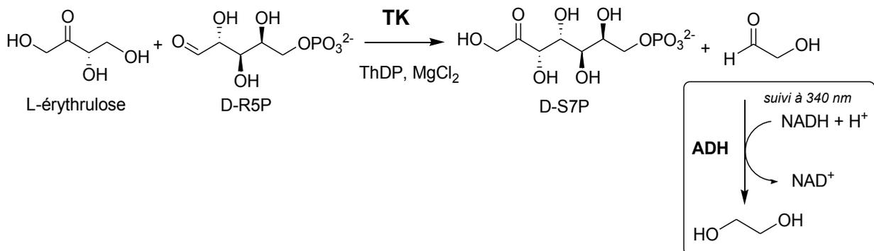
**Figure 43 : Test d'activité de la TK : « test<sub>NADH</sub> »**
