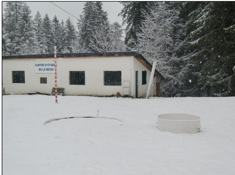
Figure 11- Lysimètre 5 m<sup>2</sup> (à gauche) et 1m<sup>2</sup> (à droite, avec jupe) sur le site d'études du CEN au col de Porte (photo prise le 6 décembre 2011).
