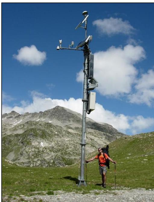
Figure 3- Nivomètre à Rayonnement Cosmique de l'Agnelin dans le massif de Belledonne, à 2200m d'altitude. Le mât permet entre autres la mesure de hauteur de neige et de température et comporte le boîtier électronique et le dispositif de transmission des informations à distance. Le capteur de rayonnement est enfoui dans le sol, et c'est uniquement cette dernière partie qui est présente au col de Porte.
