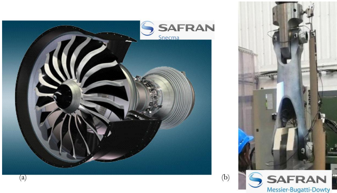
Figure Intro - 2 : Utilisations aéronautiques de l'interlock CMO, (a) Vue 3D du Leap, moteur turbofan d'architecture classique et (b) essai sur contrefiche du train d'atterrissage
