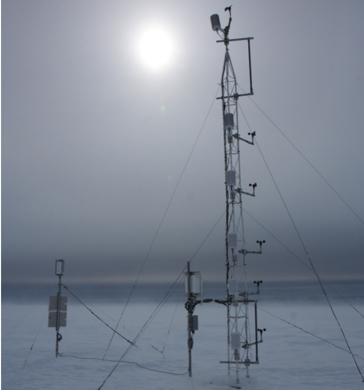
Figure 56 : photographie de la SMNA D17 avec à droite le mât de mesures, au centre le boîtier d'acquisition déporté sous le vent des vents principaux et à gauche la station énergie (crédit : Trouvilliez)
