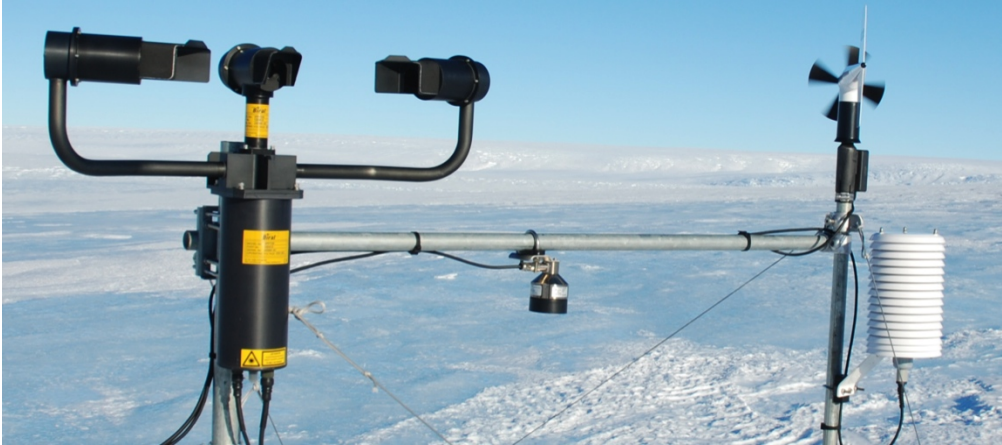
Figure 84 : le disdromètre VPF730 installé à côté de la SMNA D3 en janvier 2010 (crédit : Trouvilliez)
