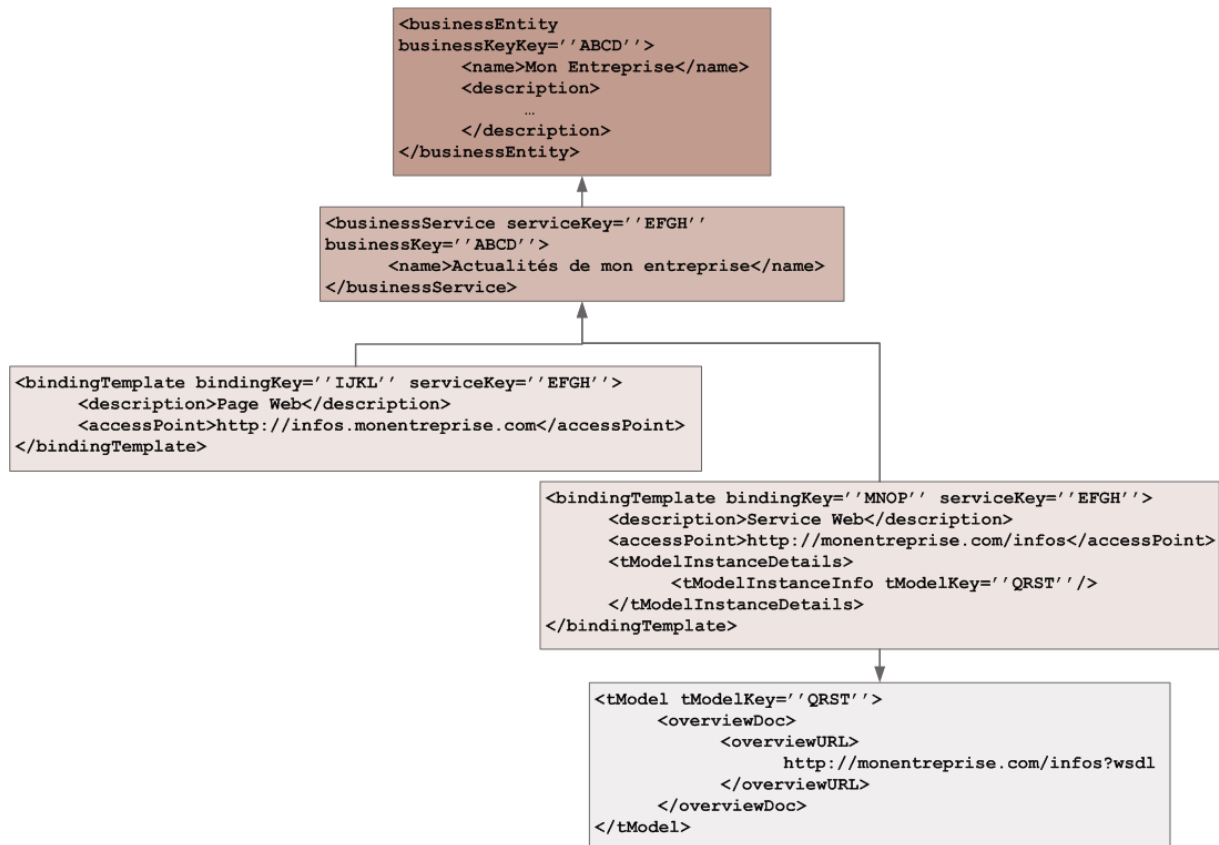
Figure 8. Fonctionnement du modèle UDDI.
