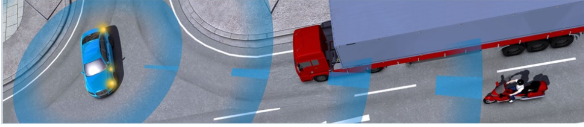
FIGURE 4.3.: Illustration de la perception coopérative où les véhicules échangent des informations pour augmenter leur champ de perception ( www.car-to-car.org )
