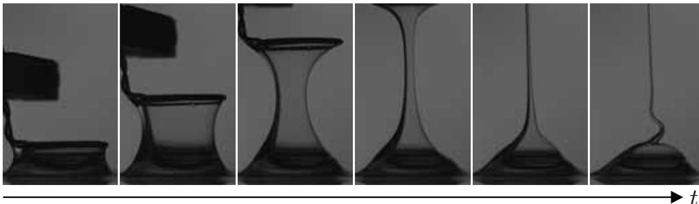
FIGURE 7.22: Séquence de photos illustrant l'effondrement d'un film visqueux (huile silicone de viscosité  $\eta_l=6.4$  Pa.s), pour un cadre de rayon  $R=0.9$  cm et une vitesse ascendante  $v = 0.3$  m.s $^{-1}$ .
