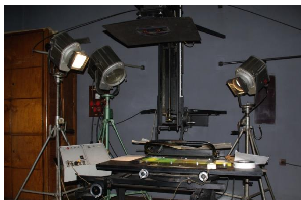
Illustration 17: Appareil banc-titre avec les feuilles en celluloïd (“Cels”) pour la préparation d’un dessin animé dans le studio d’animation Filmów Rysunkowych (Lolek et Bolek) à Bielsko-Biała. Par Janericloebe. Source: Wikimedia: http://bit.ly/18g6Rva .
