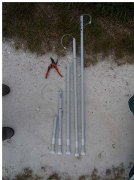
FIGURE 7.2 – Schéma et photo de tube de prélèvement de l'eau interstitielle dans les banquettes
