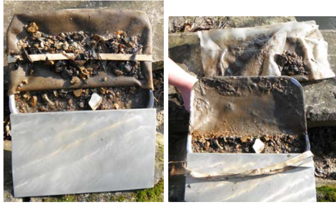
FIGURE 5.29 – Piège à sédiment plein lors de sa récupération 10 jours après sa mise en place au Carouge
