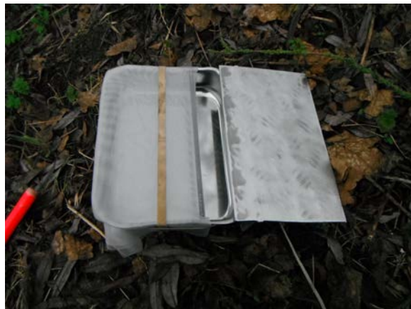
FIGURE 5.6 – Piège à sédiment
