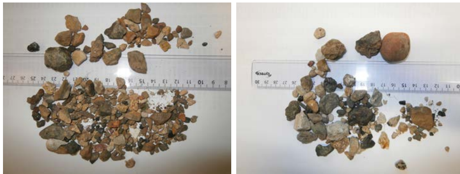
FIGURE 5.30 – Piège à sédiment : fraction supérieure à 3,15 mm récupérée dans le piège à sédiment (à gauche) et sur le piège (à droite)
