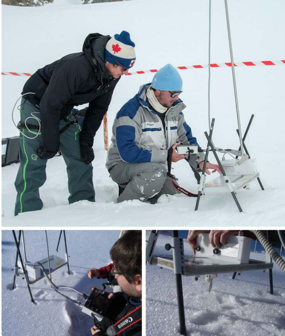
FIGURE 3.11 – Mesures de résistance à l’enfoncement avec le Snow Micro Pen. En haut : à La Grave, en avril 2013. En bas : au Col de Porte, en janvier 2012.
