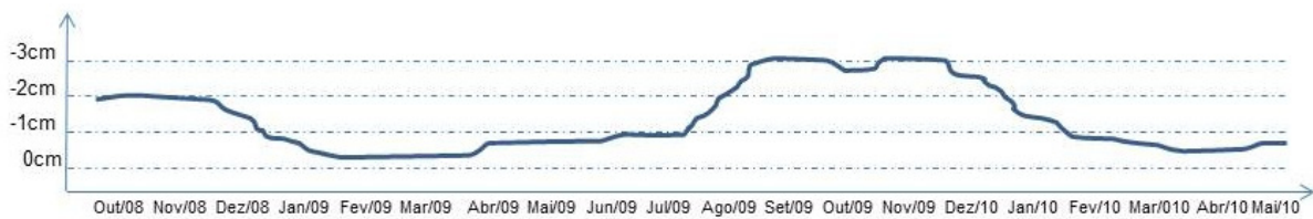
Figura 35— Gráfico da deformação gradual obtida pelo processamento InSAR das imagens Radarsat-2.
