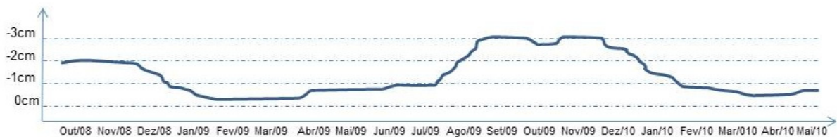
Figure 31 – Déplacement graduel temporel obtenu par le traitement InSAR de données Radarsat-2.
