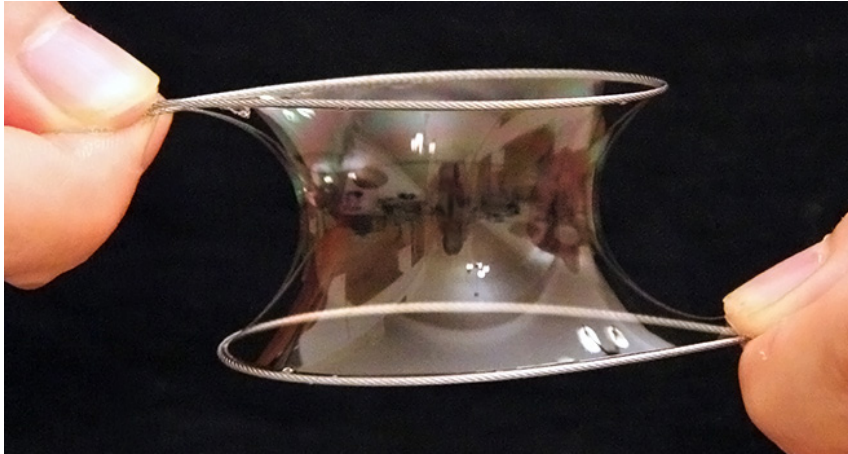
FIGURE A.1 – Photo d'un film de savon reliant deux cerceaux métalliques de même diamètre.
