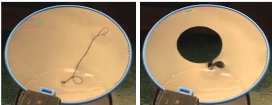
FIGURE 1.18 – A gauche, une boucle en ficelle est posée sur un film de savon. A droite, en perçant le film se trouvant dans la boucle, la force exercée par le film de savon entourant la boucle l'étire en un cercle parfait. [Loops, 2014]
