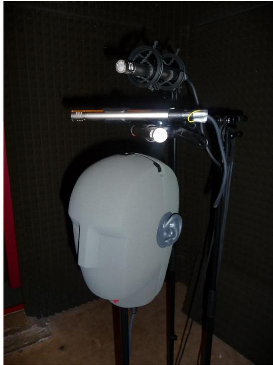
FIGURE 4.1 – Configuration des microphones pour l'enregistrement.
