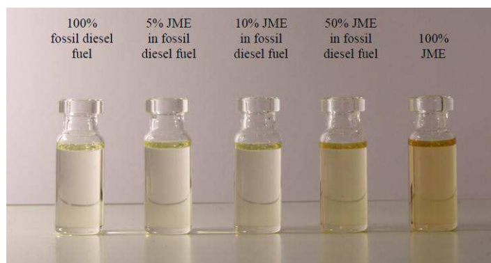
Figure 18. Exemple de l'apparence optique d'un gazole fossile et ses mélanges avec du bio-Diesel (JME : Jatropha Methyl Ester). Schönborn 2009
