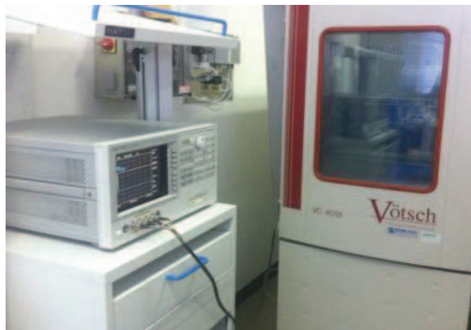
Figure 2.23 Banc expérimental pour la caractérisation des condensateurs en fonction de la température
