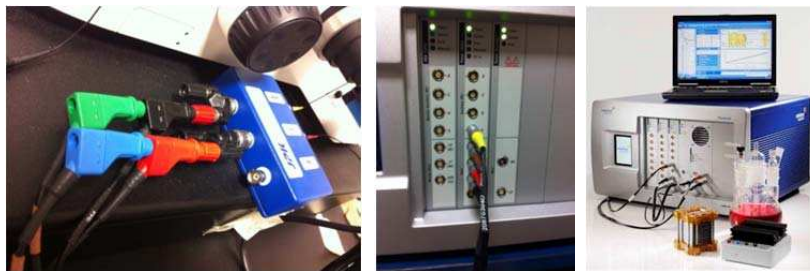
Branchement électrique reliant les électrodes au potentiostat (Solartron)
