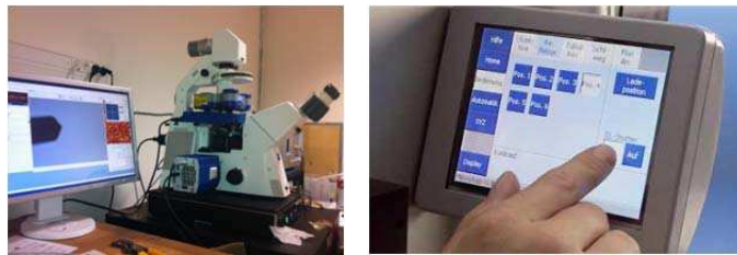
Figure 36 : Microscope à force atomique (AFM) monté sur microscope optique inversé.
