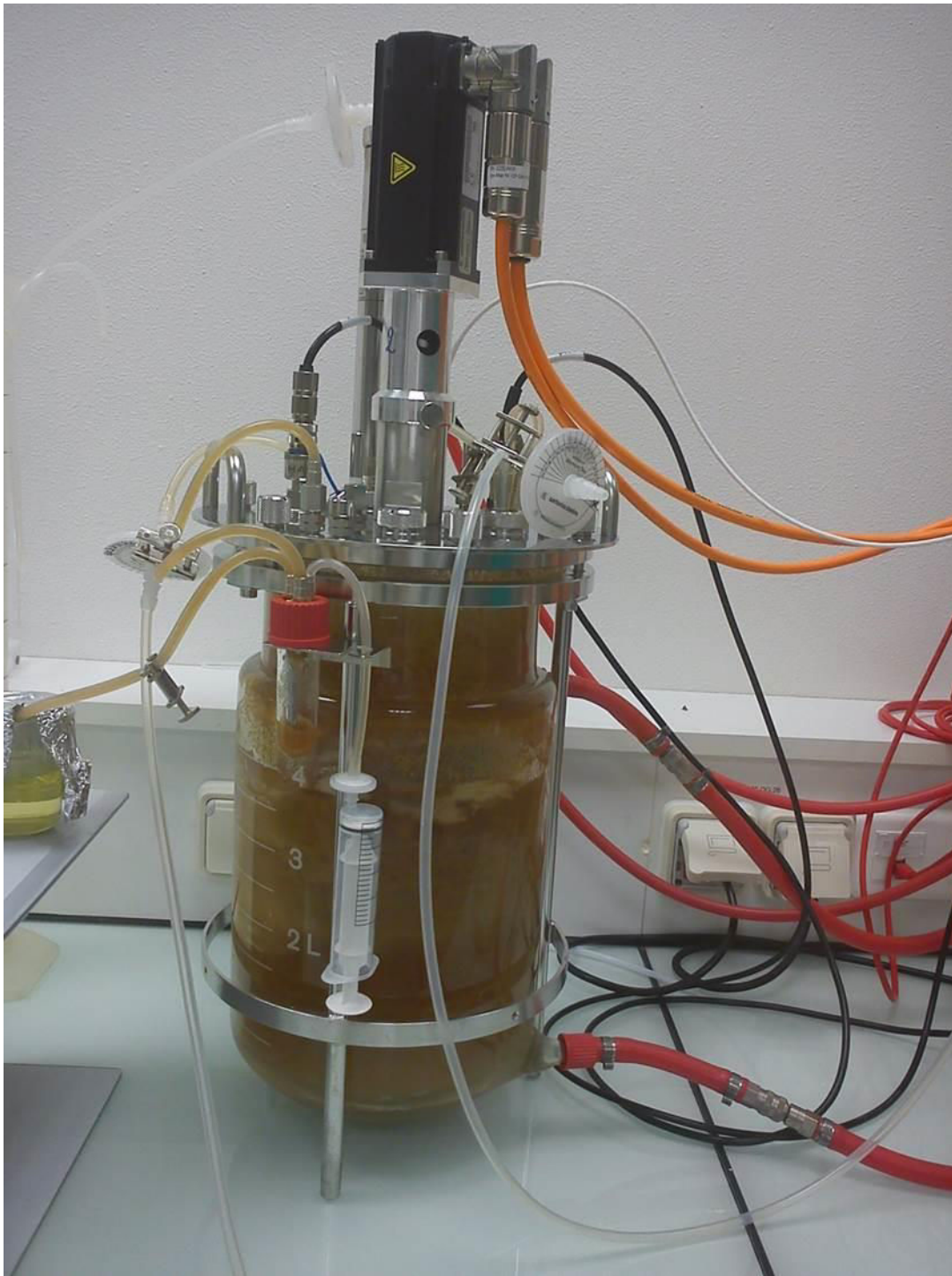
Figure 24 : Photographie du bioréacteur. On peut voir, au-dessus de la plate-forme, le moteur assurant la rotation de l'hélice, et devant la cuve, le système de prélèvement permettant le suivi de la culture.
