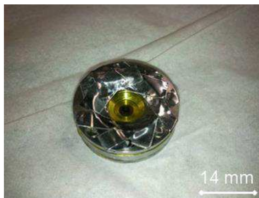
Figure 49 : Porte-échantillon recouvert de feuilles de plomb en raison de la perturbation du signal SAX au seuil K du chrome, due à la présence de traces de chrome au sein du porte échantillon en acier AISI 304L
