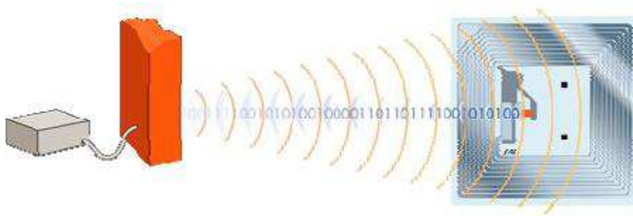
Figure 9: Briques principales composant un système RFID
