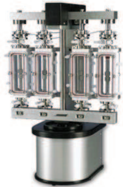
Figure I-27 : Bioréacteur Bose® ElectroForce 5200 Biodynamic
