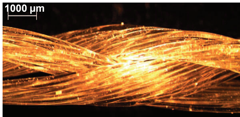
Figure IV-2 : Observation au microscope d'une matrice textile préparée par torsadage et tressage
