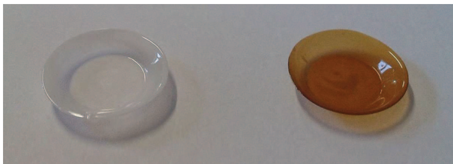
Figure III-20 : Films PLA + TA avant et après irradiation UV
