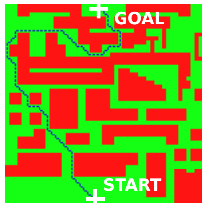
FIGURE 5.10: Trajectoire optimale (en bleu) sur la carte de traversabilité parfaitement connue.
