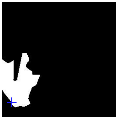
FIGURE 3.8: Exemple de résultat d'un lancé de rayons sur la carte 2.5D de la figure 3.7. En blanc les pixels visibles depuis la croix bleue.
