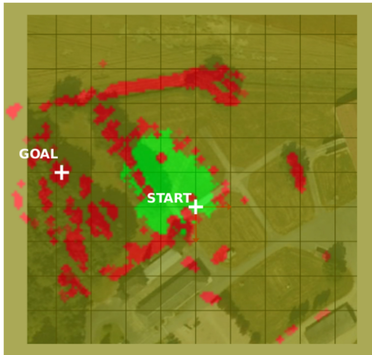
FIGURE 5.5: Superposition de la carte de traversabilité (rouge et vert) sur le fond de l'image aérienne de la zone d'expérimentation.
