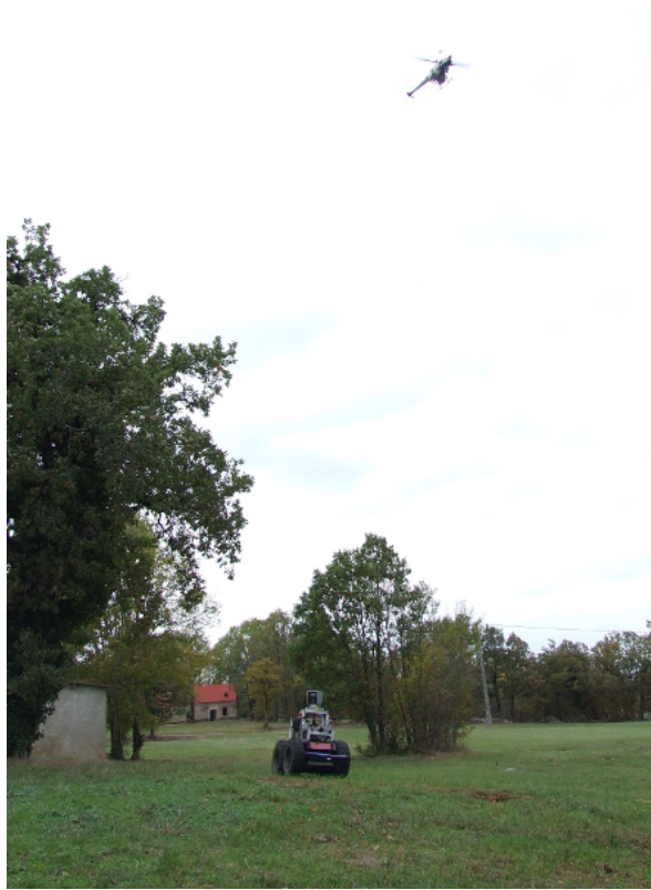
FIGURE 6.2: PEA Action - Récupération d'un blocage du véhicule terrestre. Le véhicule aérien éclaire le véhicule terrestre en utilisant le NPU .
