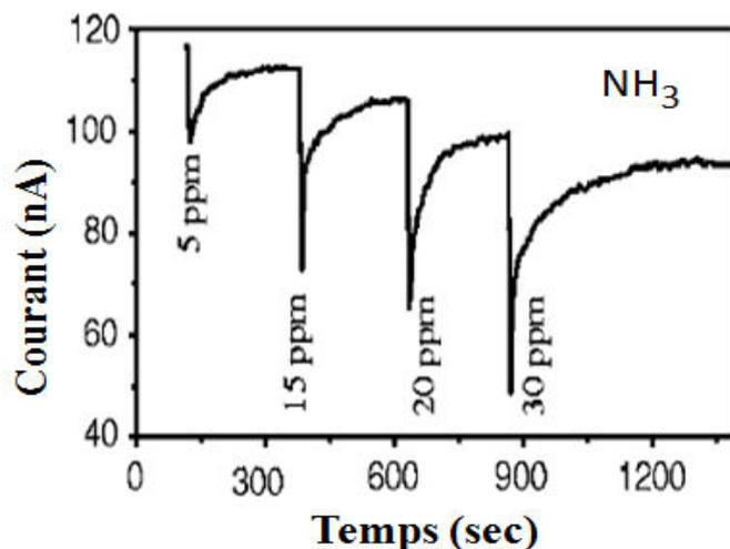
Figure I.19 : Réponses à température ambiante du capteur  $\text{SnO}_2$  à différentes concentration de  $\text{NH}_3$  [61].
