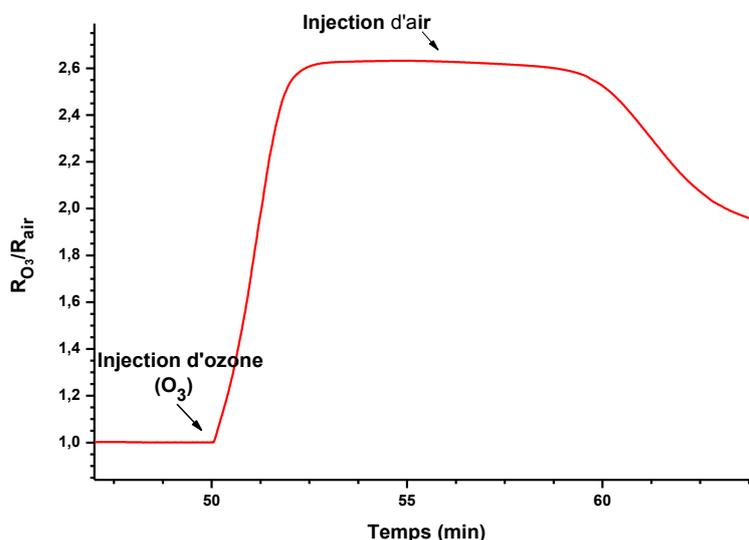
Figure III.10 : Détection d'ozone (217 ppb) à température ambiante par le capteur  $\text{SnO}_2(\text{al})$ .
