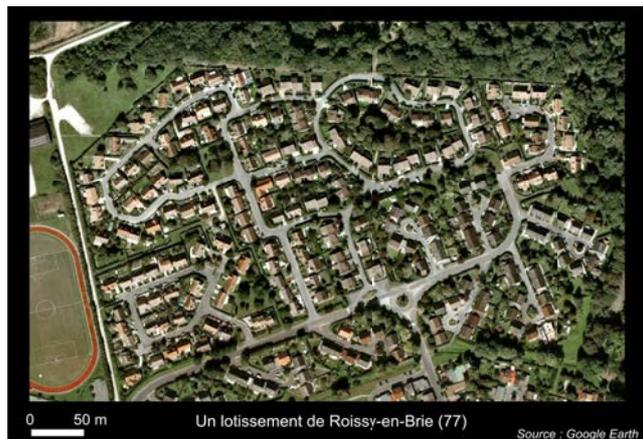
Figure 16 : Système d'impasses, de boucles et de raquettes
