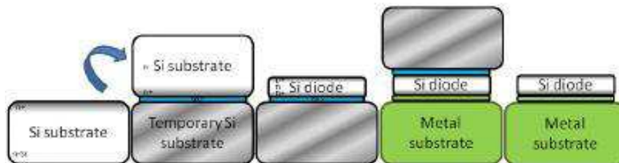
Figure 1-37 : Procédé synthétique de réalisation et report de matrices de composants à l'échelle du wafer [62]
