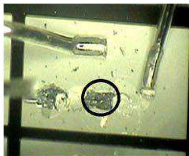
Figure 1-5 : Dégradation d'une métallisation d'une puce durant le procédé wedge bonding (photographie Advanced Power Technology Europe )
