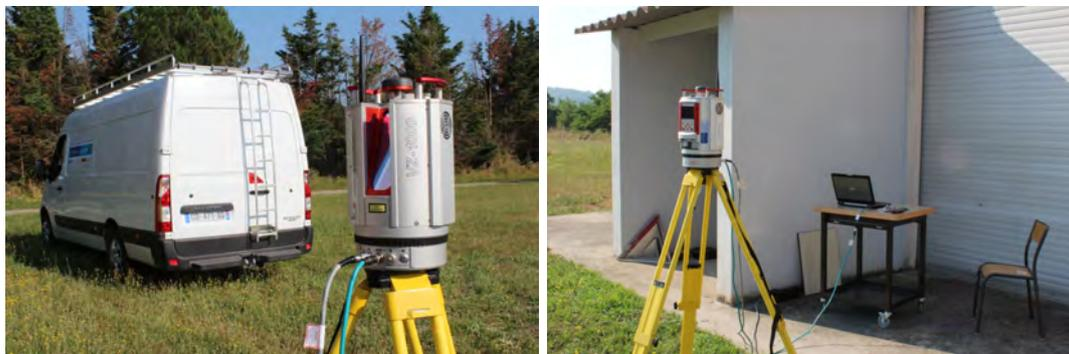
**Figure 6.13** – *Le scanner laser terrestre Riegl VZ-1000 de l'ONERA lors de la campagne de mesures du 25 juillet 2013.*
