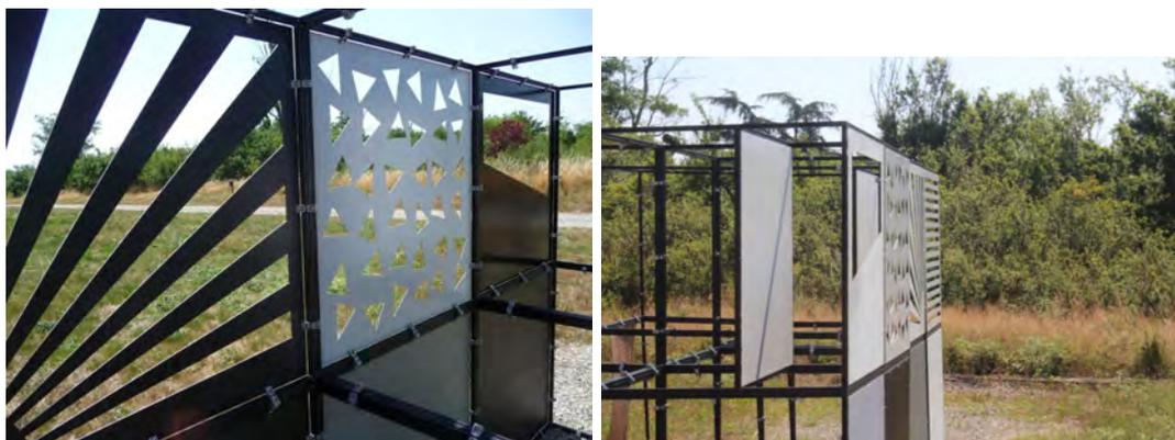
**Figure 6.16** – Mires 3D dédiées à l’observation avec le lidar onde complète. A gauche, assemblage de plusieurs cubes vu de l’intérieur. A droite, structure permettant la fixation d’un panneau intermédiaire.
