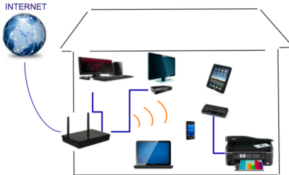
FIGURE A.1 – Exemple de réseau domestique.
