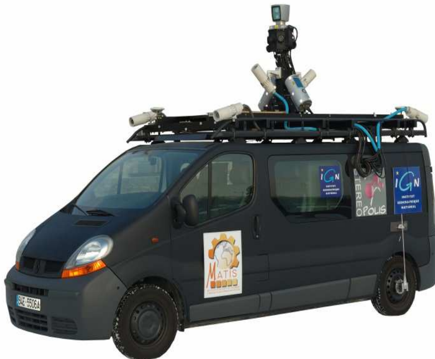
Figure A.2: Système de cartographie mobile de l'IGN baptisé Stéréopolis.
