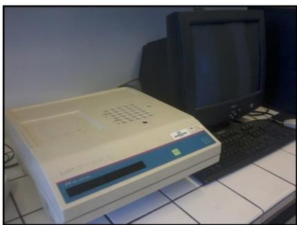
Figure 24 – Microbics M 500 toxicity analyzer utilisé pour la réalisation des tests de toxicité sur *Vibrio fisheri* dans cette étude (Photographie personnelle).
