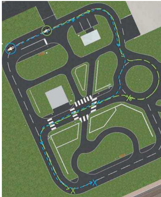
FIGURE 6.10 – Aperçu (approximatif) des trajectoires du scénario d’inversion de convoi. Les croix correspondent à des arrêts du véhicule et les cercles aux points de départ.
