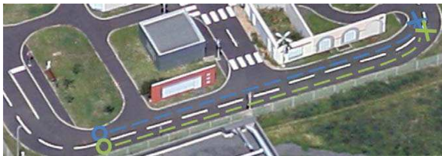
FIGURE 6.25 – Aperçu des trajectoires du scénario convoi ligne. Les cercles correspondent aux points de départ des véhicules et les croix aux arrêts.
