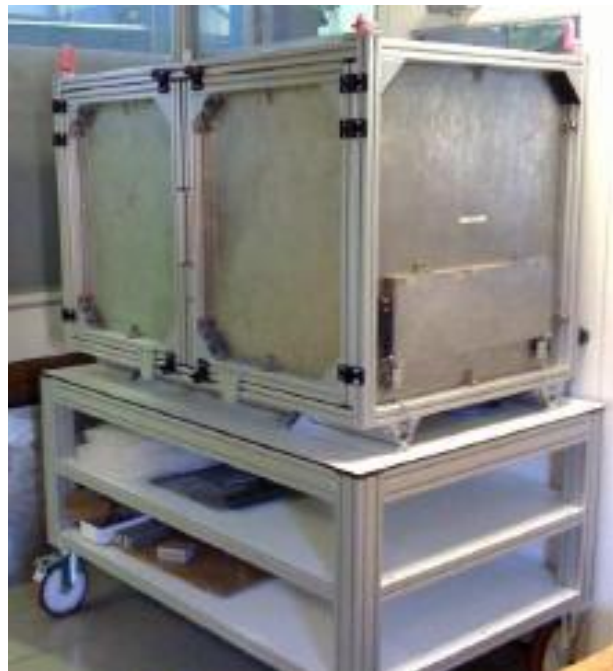
Figure 2.1 : Photographie de la boîte où est installé le PIXSCAN. On aperçoit les deux portes sur le panneau gauche ainsi que la chicane permettant le passage des câbles et de la ventilation. (Niclas, 2011).
