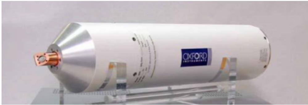
Figure 2.13 : Photographie de la source Oxford Instruments
