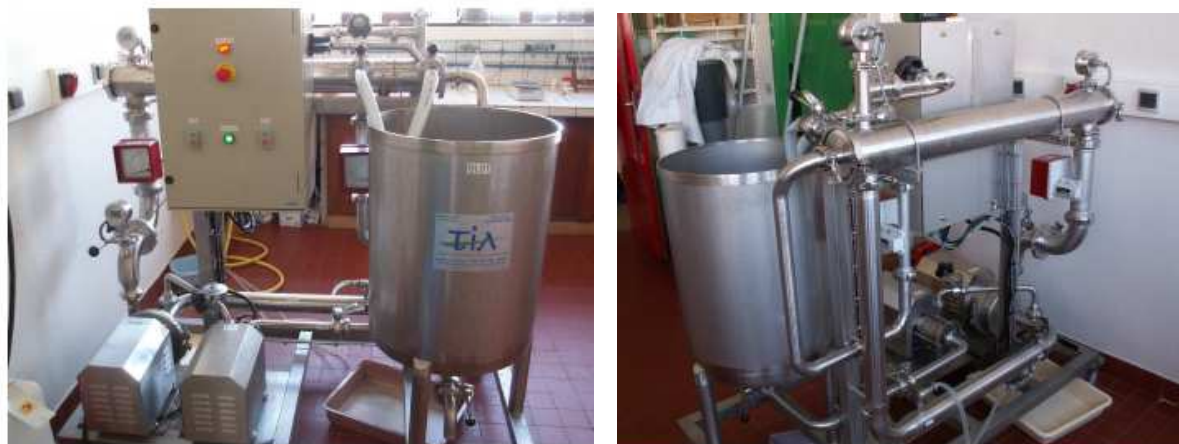
Figure II.15 Photographie du module spiral d'UF (TIA E 3093, Bollène) équipée d'une membrane HFK 131 (6.5 m 2 )
