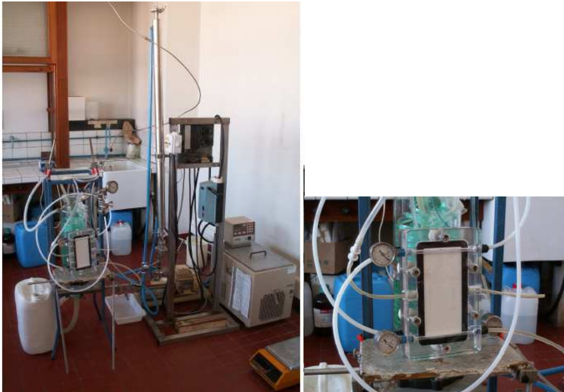
Figure II.13 Photographie du pilote plan d'ultrafiltration (gauche) et du module plan (127 cm 2 ) (droite).
