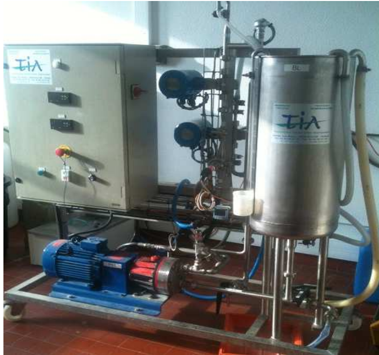
Figure II.16 Photographie du pilote spiral de NF (TIA, Bollène) équipé d'une membrane Desal 5DL (2.5 m 2 )
