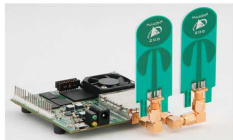
(b) Le module P410 MRM ( PulsON 410 Monostatic Radar Module ) de Time Domain.
