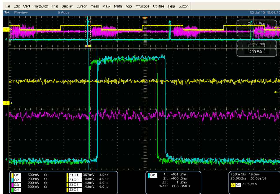
FIGURE 5.7 – Problème de synchronisation entre deux générateurs esclaves .
