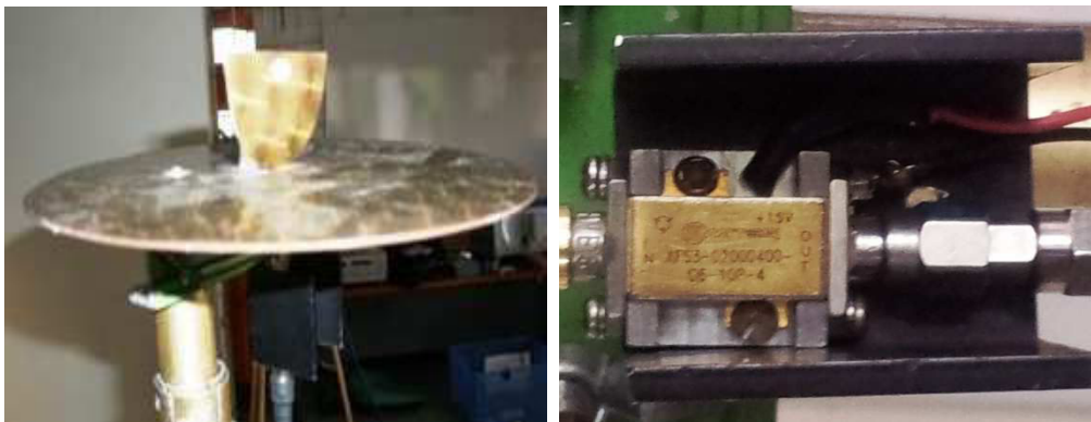
(a) Antenne monopôle utilisée en réception.
