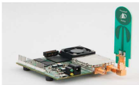
(a) Le module P410 RCM ( PulsON 410 Range Communication Module ) de Time Domain.
