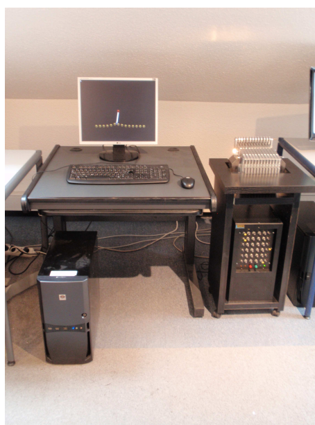
FIGURE 5.6 – La console Gamma à 12 degrés de liberté
