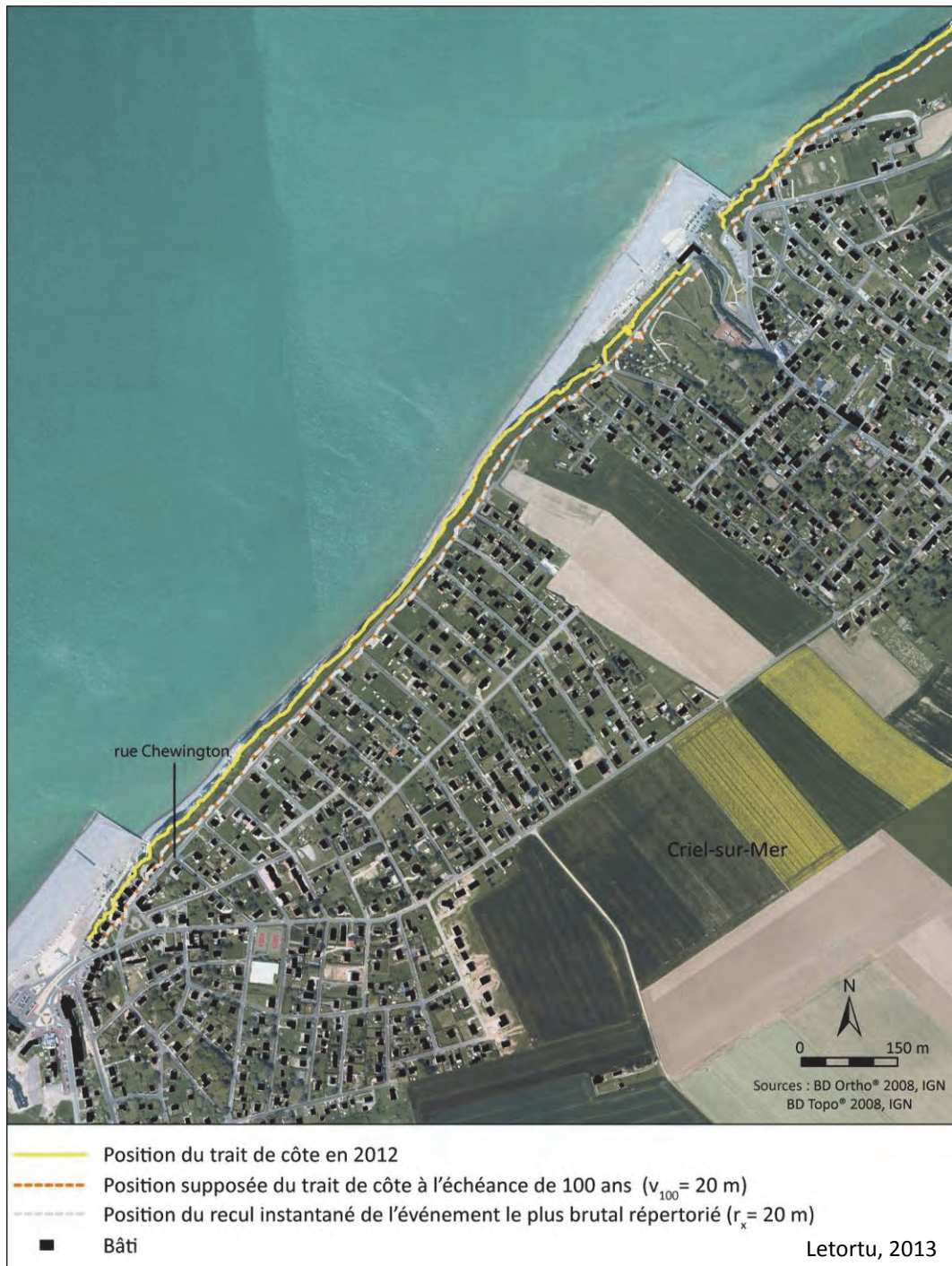
Figure 7.20 : Positions du trait de côte déduites du recul instantané maximal et de la valeur de recul moyen extrapolée sur 100 ans à Criel-sur-Mer
