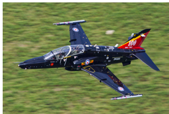
FIGURE 5.6 – Fences aux bords d'attaque et VG à l'extrados des ailes du Hawk T2
