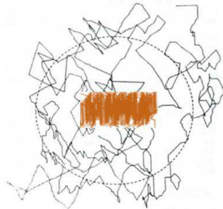
Figure 47: Illustration de l'explosion à la fusion d'une chaîne de poudre native ou d'un monocristal de UHMWPE [13].
