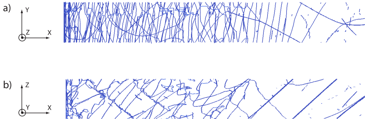
FIGURE III.6 – Allure de la microstructure de dislocations obtenue après une déformation en cisaillement de 0.28% (simulation « B4 modèle EF »). Les dislocations sont à l'équilibre dans des empilements tridimensionnels complexes qui prennent leur source sur le joint. (a) Vue selon l'axe \bar{Z} . (b) Vue selon l'axe \bar{Y}
