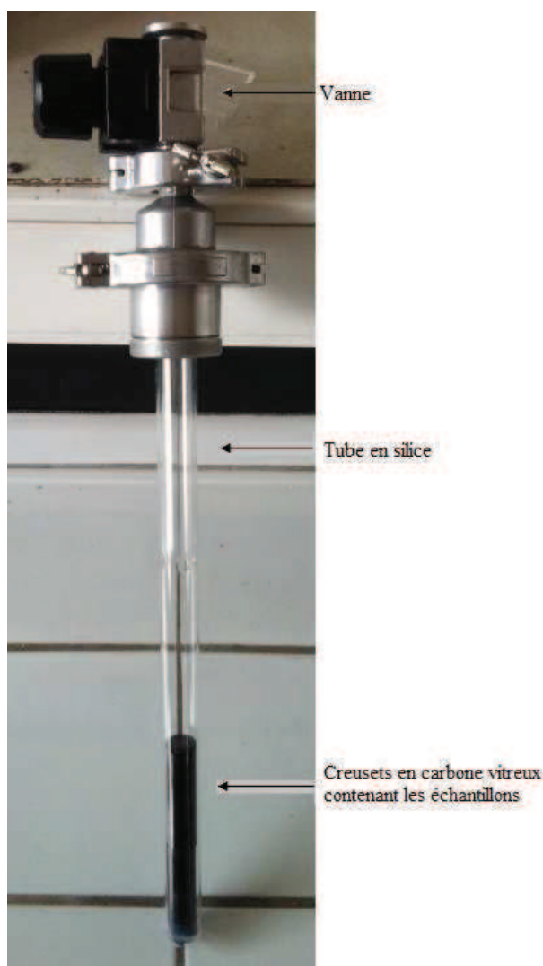
Figure IV.7 : Photo représentant les creusets encapsulés dans un tube en silice
