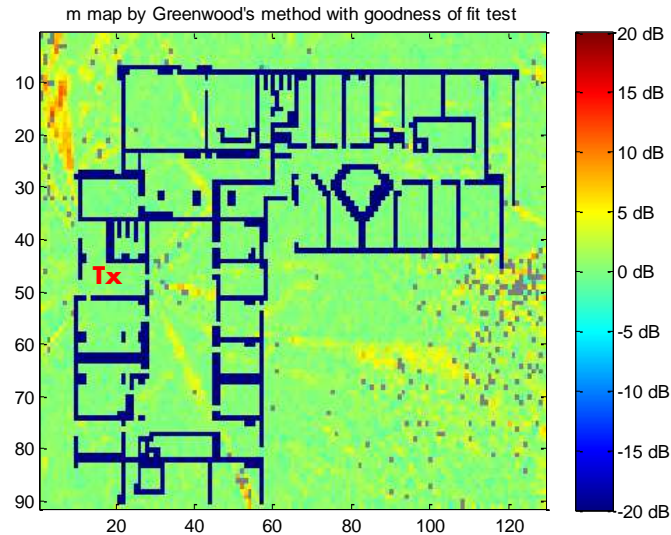
Figure 52. Cartographie de la valeur du paramètre m pour un modèle de canal Nakagami- m (en dB). Les points gris représentent les zones où le test de validité de l'estimation du paramètre K a échoué. Tx représente l'emplacement de l'émetteur.
