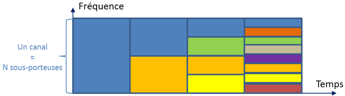
Figure 12. Partage d'un canal fréquentiel en technique OFDMA : attribution de sous-porteuses à différents utilisateurs.
