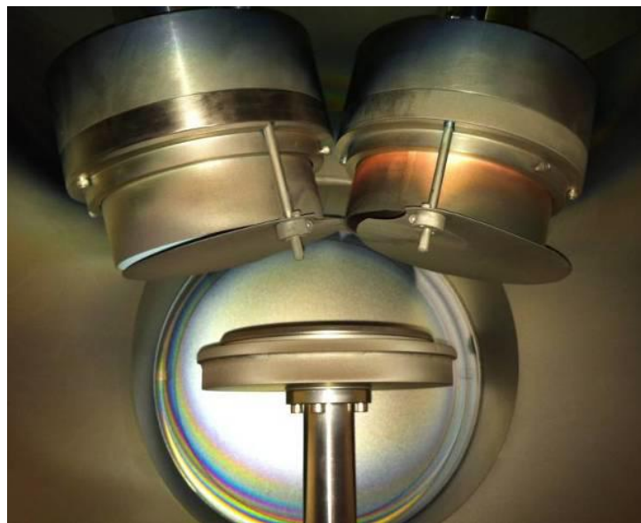
Figure15. Photo de l'intérieur de l'enceinte de dépôt par pulvérisation cathodique du LAAS. Visualisation du porte substrat et des deux cibles masquées
