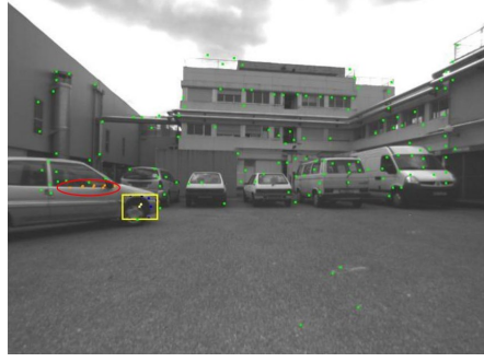
FIGURE 3.16 – Cette image montre les résultats de la méthode de groupement le long de deux temps de piste. Dans le rectangle le groupe dynamique détecté lors du premier temps de pistage , dans l'ellipse les résultats lors du deuxième temps de pistage .
