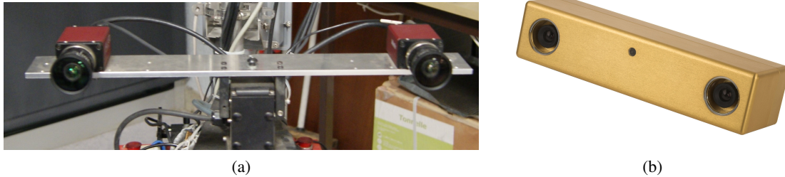
FIGURE 2.3 – a) Banc stéréo embarqué sur notre démonstrateur Dala (figure 5.10) b) Système de stéréovision Bumblebee2 fabriqué par Point Grey Research©.
