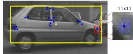
FIGURE 4.2 – Les points dynamiques en bleu forment le modèle de l'objet mobile, délimité par le rectangle. Un motif de 11 \times 11 pixels est extrait autour de chaque point détecté sur l'objet mobile.
