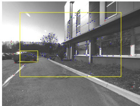
FIGURE 5.1 – Résultats de la détection sans compensation de mouvement : un grand objet dynamique est détecté, alors que la voiture est le seul objet en mouvement dans la scène.
