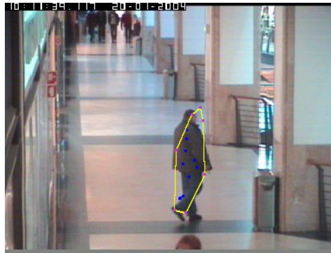
FIGURE 4.5 – Contour actif initial dérivé des points les plus éloignés du centre.
