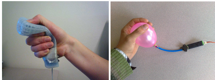
FIGURE 7.25 – Dispositifs construits à partir de capteurs physiques interface-Z [Interface-Z, 2010] : le Wiisoft, à gauche (capteur de torsion) et le ballon, à droite (capteur de pression).
