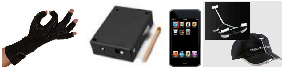
FIGURE 7.22 – Dispositifs de capture de gestes : de gauche à droite, Dataglove, Shake, iPhone et trackIR.
