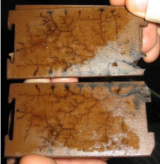
Figure 30 : Décharges partielles sur des cales
