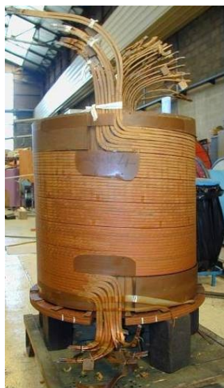
Figure 8 : Enroulement de transformateur
