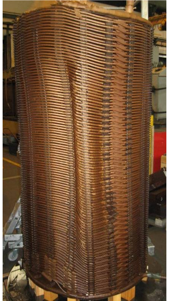
Figure 33 : Déformation mécanique d'un enroulement
