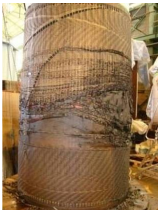
Figure 19 : Amorçage franc entre spires
