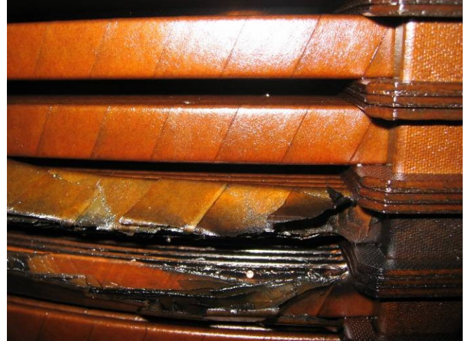
Figure 27 : Amorçage entre spires, sans court-circuit entre-elles
