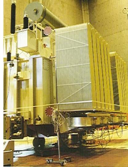
Figure 13 : Radiateurs sur un transformateur
